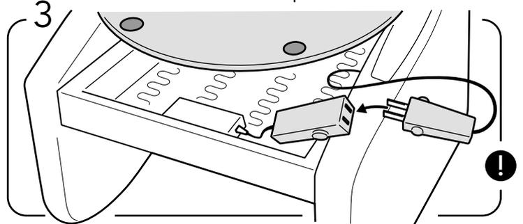
Conecte la batería. El cable alimentará el motor.
