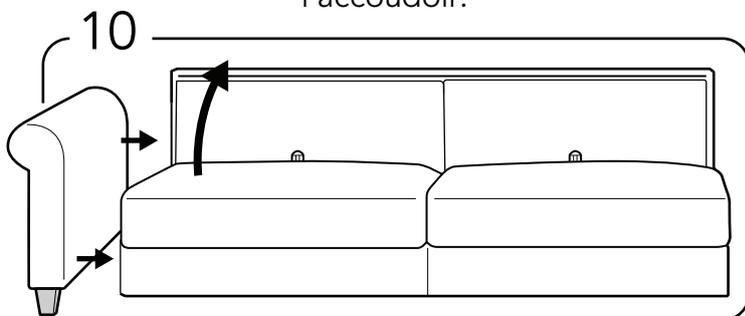
Changez la position de l'accoudoir opposé au contraire et attachez-le en ouvrant le mécanisme du lit.
