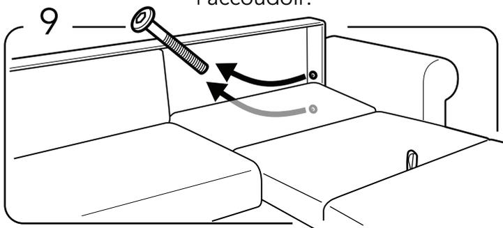
Baissez le mécanisme du lit et retirez les deux boulons qui fixent le dossier.
