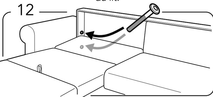
Baissez le mécanisme du lit et vissez les deux boulons pour fixer le dossier.
