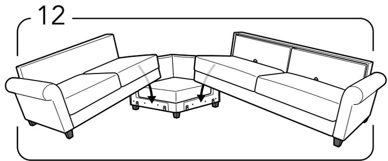
Attachez le lit et le canapé immobile au coin avec les ancrages préinstallés.
