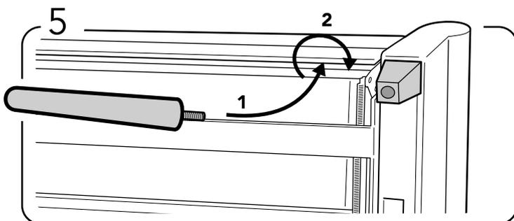
Installez les pieds du support sur place en les vissant dans les trous percés au sens horaire.
