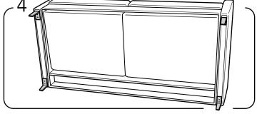
Installez le pied métallique et vissez les deux boulons (M6X25mm) dans les trous percés.
