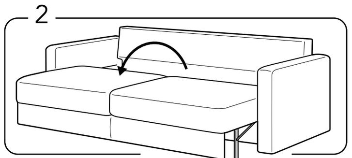
Mettez les accoudoirs à droite et à gauche à leur place. Puis, ouvrez complètement le mécanisme.
