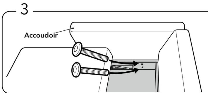
Attachez la charpente du canapé aux accoudoirs à droite et à gauche avec quatre boulons (M6x50mm) à chaque côté.
