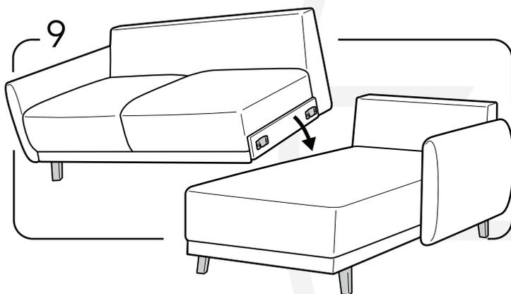
Una la litera con el diván como se muestra en la imagen. ¡Asegúrese de que ambas placas metálicas se unan correctamente!
