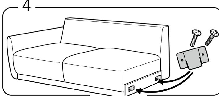
Una las placas metálicas anteriormente desmontadas con pernos M6x20 al lado de la litera.
