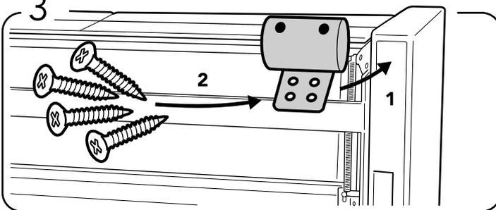
Installez le pied métallique et vissez les quatre vis à bois (3,5mmX25mm).
