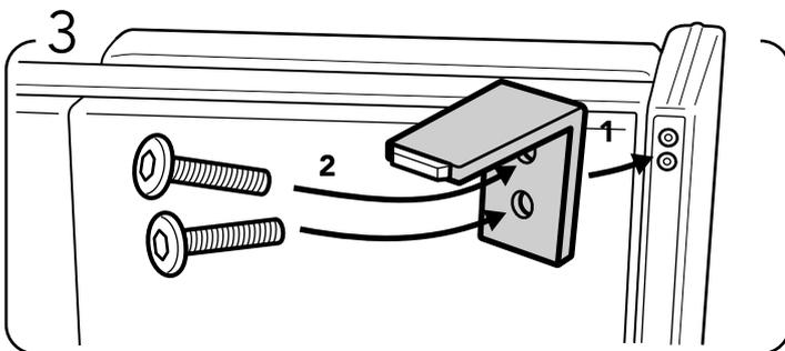
Instale la pata metálica y atornille los dos pernos (M6X25mm) en los agujeros presentes.
