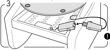
Raccordez la batterie. Le fil électrique alimente le moteur.
